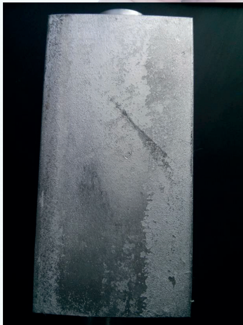
Verzunderte Oberfläche nach dem galvanisch Verzinken
